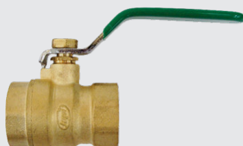
Registro de esfera latão passagem plena Pressão máxima: 60 m.c.a. Temperatura máxima: 80° C
